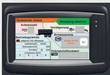
Während der Messung erkennt der Anwender sofort, ob die jeweilige Messung im gewünschten Bremsband liegt. Anschliessend werden, wenn mehrere Achsen vorhanden sind, die Werte addiert und das Resultat wird visuell im Bremsband angezeigt. Der Anwender erkennt bereits auf dem Handmessgerät, ob eine Messung den gesetzlichen Vorgaben entspricht oder nicht.
