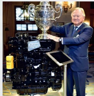
Der Wasserstoff-Verbrennungsmotor von JCB, auf dem Bild präsentiert vom Vorsitzenden Lord Bramford, wird versuchsweise in Teleskopladern und Baggerladern eingesetzt.
