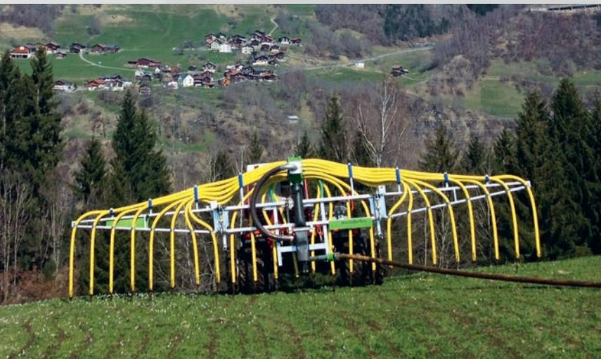
Mit dem Schleppschlauch werden die gesetzlichen Anforderungen erfüllt. Die begüßbare Fläche von maximal 20 % wird eingehalten. Bild: Hochdorfer Technik AG
