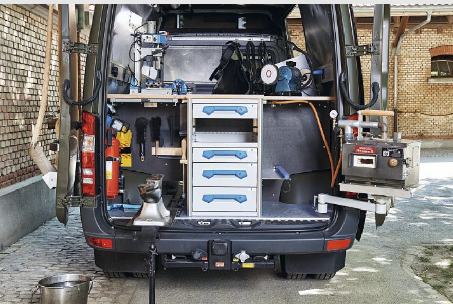
Massgeschneiderte, mobile Sortimo-Fahrzeugeinrichtung für Hufschmiede.
