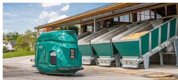
▲ GEA: Der Fütterungswagen F4500 fährt autonom zwischen den Futterbunkern und dem Stall hin und her.
