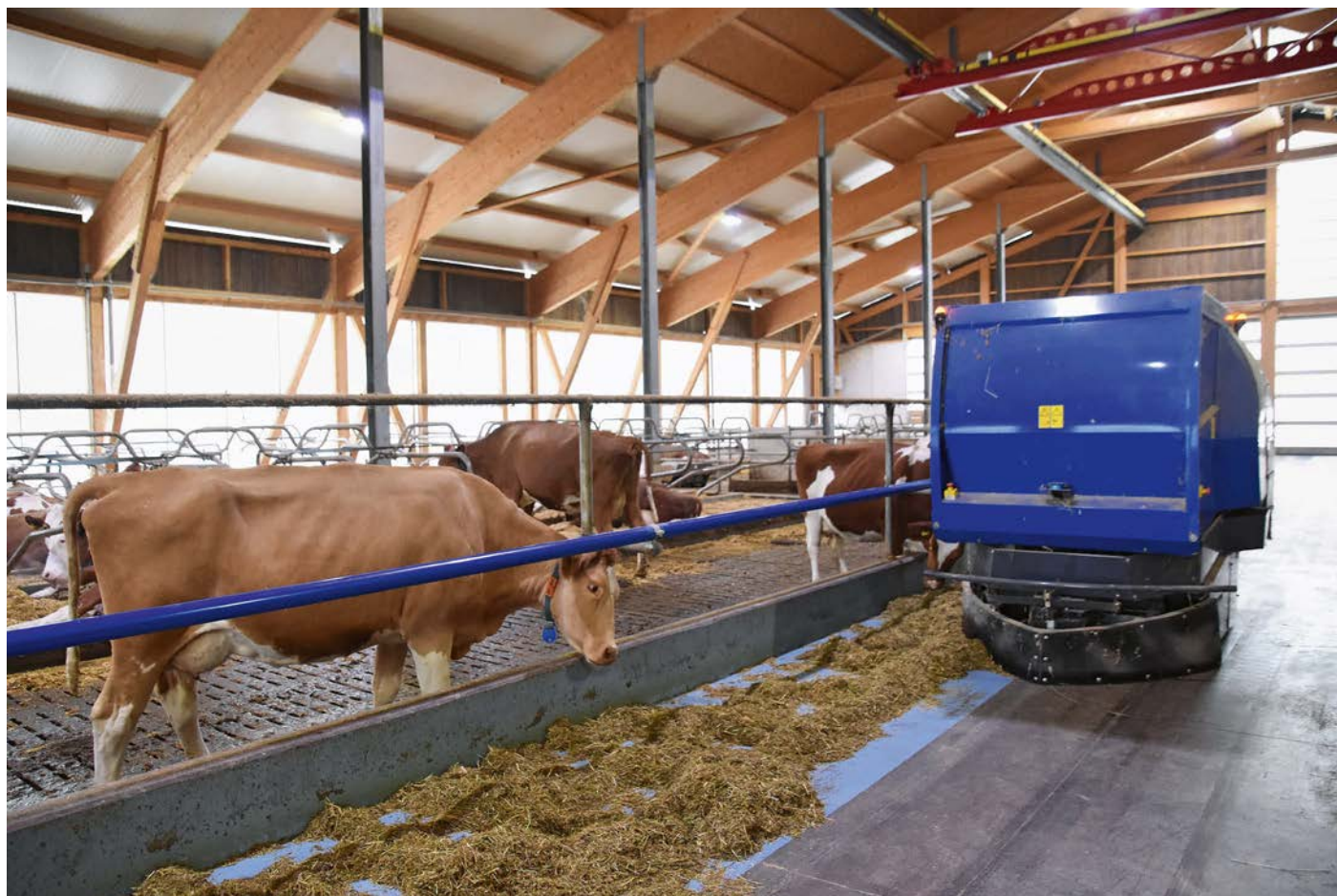
DeLaval: Der bodengeführte Verteilwagen ist gleichzeitig Zuschieber.
