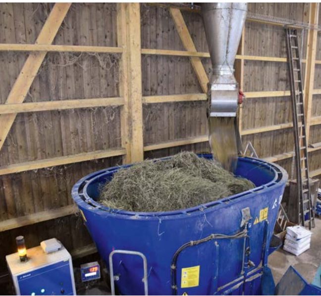
DeLaval: Der Mischer wird manuell beschickt.
