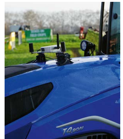
Des systèmes post-équipement permettant de conduire les tracteurs conventionnels avec précision ont également été exposés.
