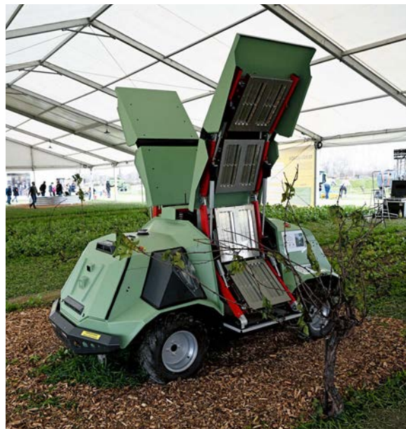
L'ICARO X4 de Masschio Gaspare combat les maladies de la vigne avec la lumière UV.
