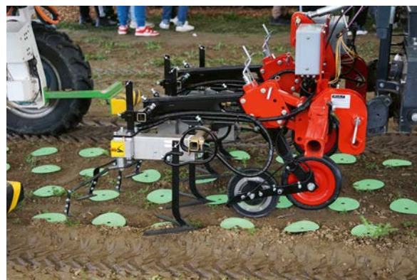
L'appareil polyvalent « Orio » de Naïo Technologies a ici été combiné avec une bineuse de précision de K.U.L.T.
