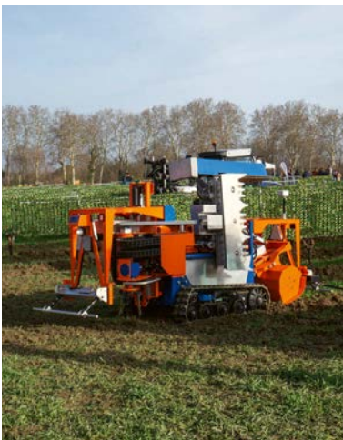
Le système multifonctionnel Agilehelper de PEK Automotive se déplace de façon entièrement autonome, sans GPS.
