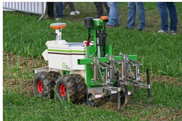
Petit, compact et de plus en plus fréquent dans la culture maraîchère : le robot « Oz » de Naïo Technologies.
