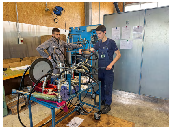
Florian Projer führt – beobachtet von Experte Urs Däscher – die Funktionsprüfung an einer selbst aufgebauten hydraulischen Lenkung durch.
