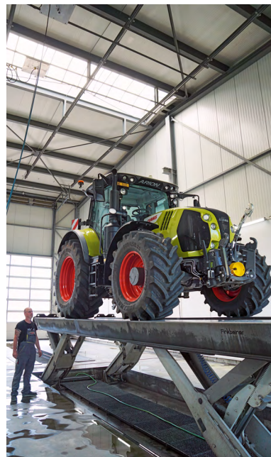
Die Industriewaschanlage mit zwei Hebebühnen
