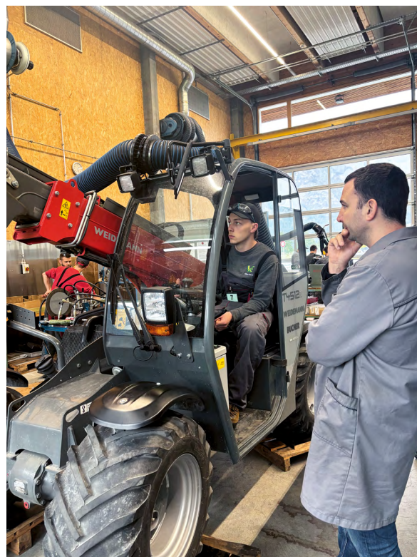
Julian Grimm und Experte Natan Bigger am Posten Hydraulik. Funktionsprüfung der Hydraulik des Teleskopladlers.
